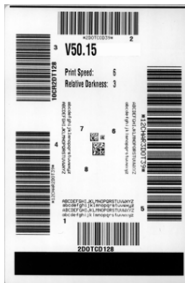
Рис. 19 • Образец этикетки для тестирования настроек темноты и скорости печати
