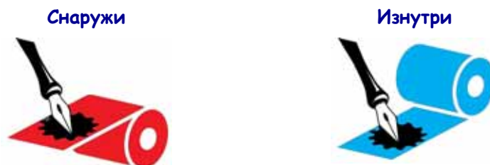
Рис. 7 • Лента с покрытием снаружи или изнутри
